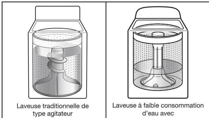
La laveuse ajuste automatiquement le niveau d'eau en fonction de la taille de la charge — nul besoin de sélecteur de niveau d'eau.
