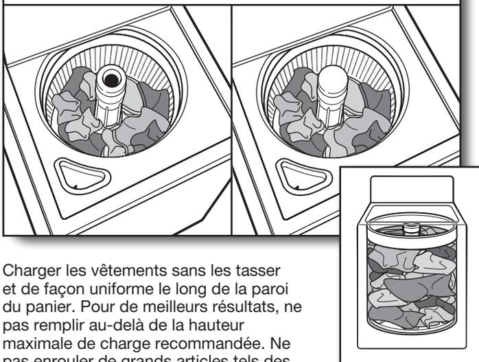
Charger les vêtements sans les tasser et de façon uniforme le long de la paroi du panier. Pour de meilleurs résultats, ne pas remplir au-delà de la hauteur maximale de charge recommandée. Ne pas enrouler de grands articles tels des draps autour de l'agitateur; les charger sans les tasser le long de la paroi du panier. Essayer de mélanger différents types d'articles pour réduire l'emmêlement.
