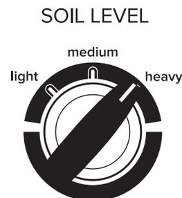
Après avoir sélectionné un programme, sélectionner le niveau de saleté en tournant le bouton Soil Level (niveau de saleté) au réglage désiré.
