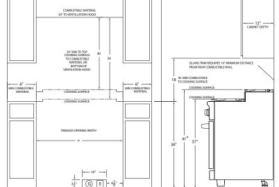
ISLAND OR PENINSULA INSTALLATIONS 10" MINIMUM CLEARANCE FROM BACK OF RANGE TO COMBUSTIBLE SURFACE ISLAND TRIM IS 0". G E LOCATION OF GAS AND ELECTRICAL SUPPLY NO SIDE WALL ABOVE COOKING SURFACE
