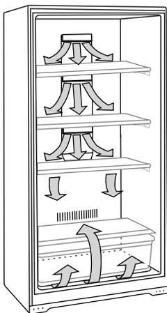
Ne pas obstruer l'une ou l'autre de ces ouvertures d'aération avec des emballages d'aliments. Si les ouvertures d'aération sont bloquées, le courant d'air sera coupé et des problèmes de température et d'humidité peuvent survenir.
