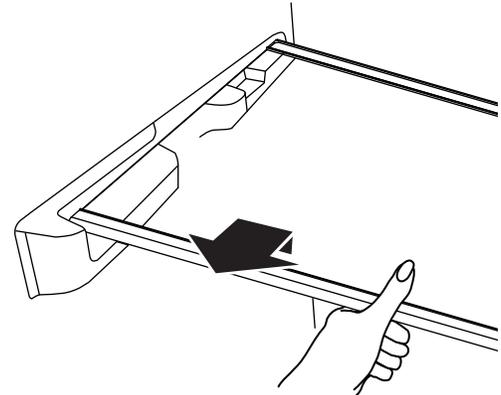
2. Réinstaller la tablette en l'abaissant sur les supports situés sur la paroi latérale.
