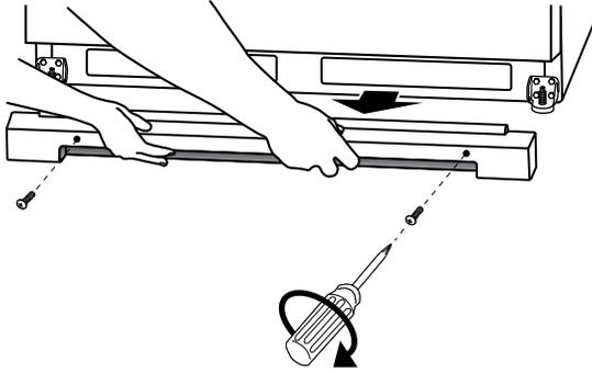
8. Réinstaller la grille de la base en alignant les extrémités de la grille avec les dispositifs de nivellement de chaque côté et emboîter la grille. Réinstaller les vis.
