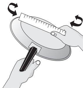
Figure 6 : Vérifier la planéité des ustensiles
