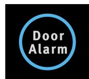
Para encender el alarma de la puerta, presione el botón del ALARMA de la PUERTA una vez. La luz ACTIVADO será encendido. Para apagarlo, presiónela otra vez. Cuando la ALARMA de la PUERTA esta activado, la luz ACTIVA destellará al abrir la puerta y la señal sonora si mantiene la puerta abierta por más de 2 minutos. La luz se apaga y el sonido se para al cerrar la puerta.
