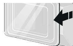
Levez la partie arrière de l'écran en verre et retirez-le
