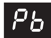
Figure 10 : Niveau amplification de la puissance
