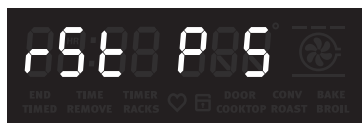
Fig. 62 Le four est maintenant prêt à se réinitialiser aux réglages par défaut
