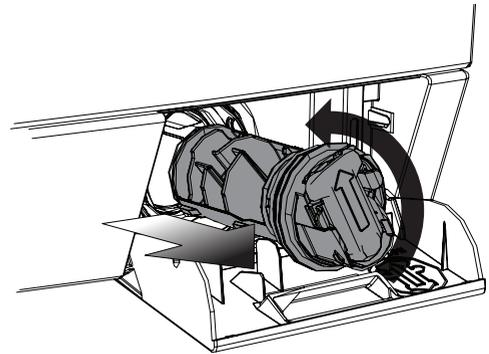
Inspectez le joint annulaire avant de réinsérer le filtre de la pompe
