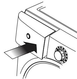
Insérez le réservoir de détergent liquide lorsque vous utilisez un détergent liquide.
