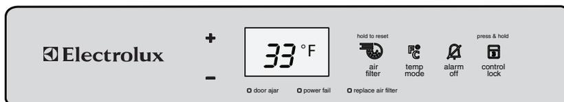
Para regular la configuración de temperatura, en el panel de control presione la tecla ARRIBA (+) para temperatura más cálida y la tecla ABAJO (-) para temperatura más fría. Espere varias horas entre los ajustes para que la temperatura se establezca. La unidad se puede regular entre 33 °F (1 °C) y 46 °F (8 °C). Al presionar la tecla MODO DE TEMPERATURA, la pantalla de temperatura cambiará entre °F y °C.
