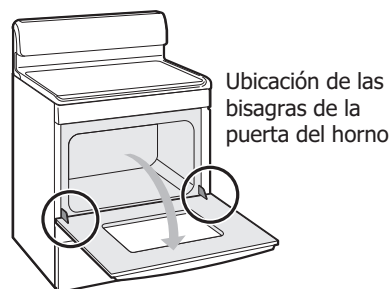
Figure 34 : Emplacement des charnières de la porte
