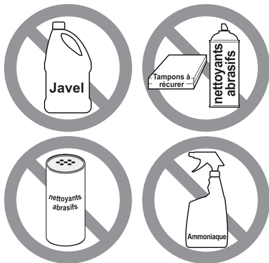
Figure 31: Produits de nettoyage à éviter
