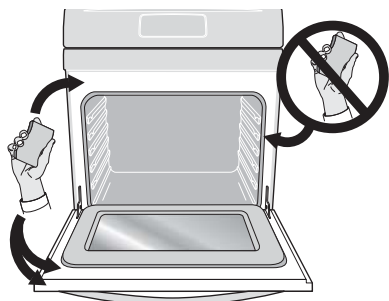
Figure 20 : Nettoyer autour du joint de porte du four
