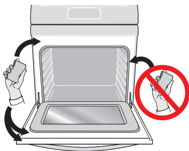
Figure 28 : Nettoyer autour du joint de porte du four
