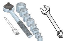
Llave de tubo o fija de 7,93 mm, 9,52 mm y 14,28 mm
