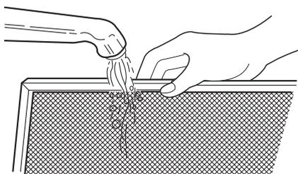
2. Faites tremper les filtres dans un mélange d'eau chaude et de détergent doux. Rincez bien et secouez pour sécher ou les lavez au lave-vaisselle. **N'utilisez pas d'ammoniaque** L'aluminium contenu dans le filtre se corroderait et se ternirait.
