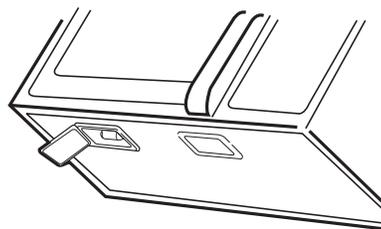
3. Remplacez l'ampoule par une ampoule de 40 watts pour électroménagers.
