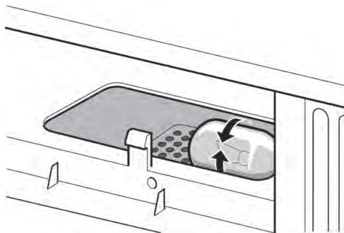
**REMARQUE : NE PAS UTILISER UNE AMPOULE DE PLUS DE 30 W**
