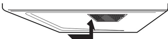
3. Pour réinstaller le filtre, glissez-le dans la fente et poussez vers le haut en direction du four pour le verrouiller. Recommencez la procédure pour installer le second filtre.
