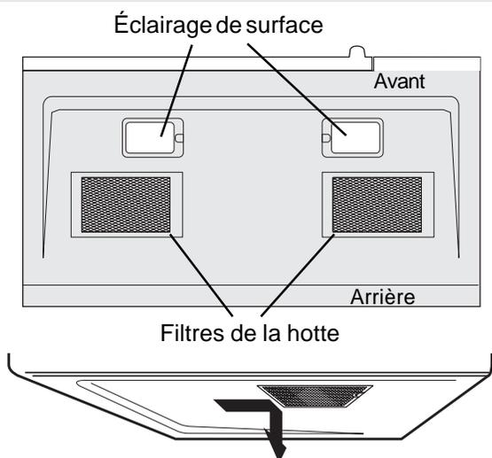
1. Pour retirer un filtre, faites-le glisser sur le côté. Tirez ensuite le filtre vers le bas et poussez l'autre côté. Le filtre se détache. Répétez l'opération pour le second filtre.
