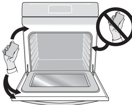
Figure 18 : Nettoyer la partie autour du joint de la porte du four
