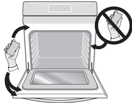
Figure 17 : Nettoyer la partie autour du joint de la porte du four
