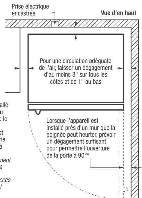
\* Lorsque le congélateur est installé près d'un mur, d'une armoire ou d'un autre appareil qui dépasse le bord avant du congélateur, un dégagement minimal de 20" est recommandé pour permettre une ouverture optimale de la porte à 140°, pour l'accès ou le retrait complet du panier. (Le dégagement minimal absolu de 3" permettra l'ouverture de la porte à 90° SEULEMENT, ce qui limitera l'accès au panier, ainsi que son retrait.)
