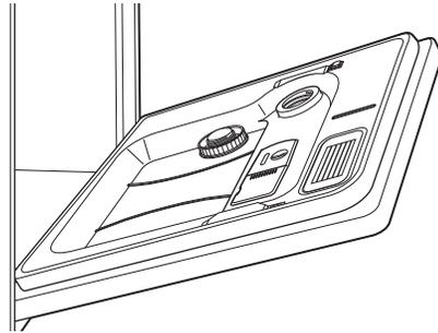
Placez la bouteille de détergent vis-à-vis de l'ouverture dans la porte et remplissez le distributeur.
