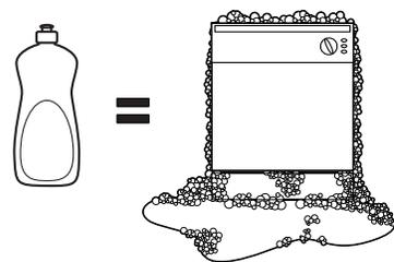
**REMARQUE :** Si vous utilisez un détergent qui n'est pas conçu pour les lave-vaisselle, il se formera de la mousse à l'intérieur de l'appareil. Pendant le fonctionnement, cette mousse sortira par les événements de l'appareil et s'écoulera sur le plancher de cuisine.
