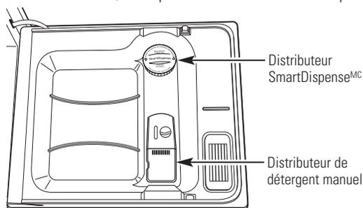
Le couvercle de la section pour le lavage principal s'ouvre pendant le cycle de lavage. Si vous utilisez le distributeur SmartDispense<sup>MC</sup>, laissez le couvercle du distributeur pour le lavage principal ouvert avant de mettre le lave-vaisselle en marche.
