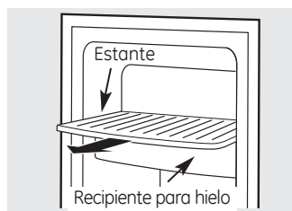
Para llegar al interruptor de corriente.
