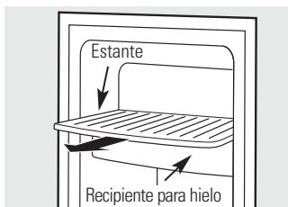
Para llegar al interruptor de corriente.
