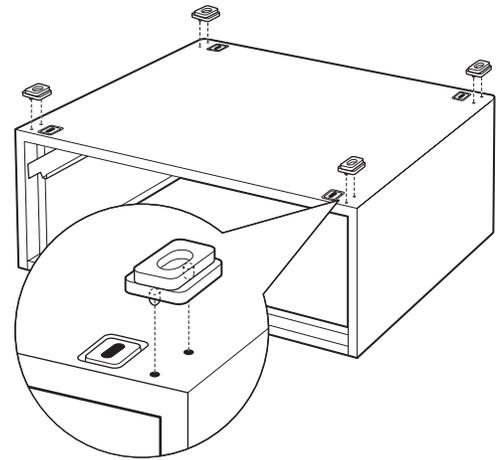
**REMARQUE : les coussinets de support doivent être installés seulement sur la sécheuse. N'INSTALLEZ PAS CES COUSSINETS SUR LE PIÉDESTAL DE LA LAVEUSE.**
