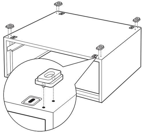
**NOTA:** Las planchuelas de soporte deben instalarse en la secadora únicamente. **NO INSTALE LAS PLANCHUELAS EN EL PEDESTAL PARA LA LAVADORA.**
