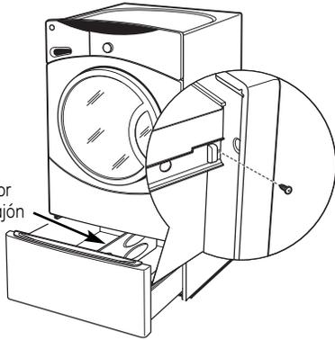
**C** Vuelva a instalar los tornillos originales en cada una de las correderas del cajón. Apriete ambos tornillos.
