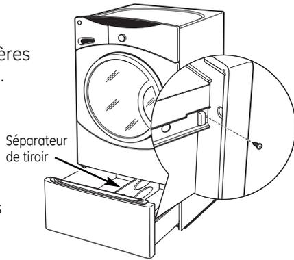
**C** Réinstallez les vis originales dans chaque glissière de tiroir. Resserrez les deux vis.
