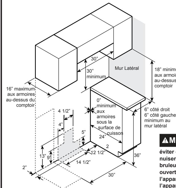
**AVERTISSEMENT** Pour éviter que les courants d'air nuisent au fonctionnement du brûleur, bouchez toutes les ouvertures dans le sol sous l'appareil et derrière le mur de l'appareil.
