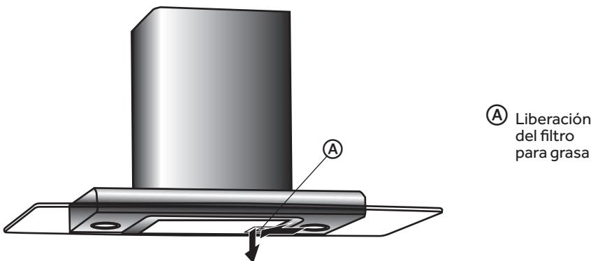
2. Lave el filtro de metal, según fuera necesario, en la lavavajillas o con una solución de agua caliente y detergente para vajilla.
