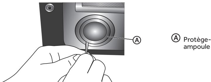
3. Tirer délicatement sur l'ampoule pour la sortir de la douille.
