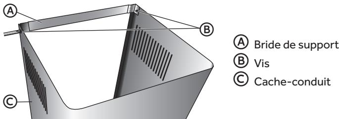
2. Fixer la bride du cache-conduit au mur en affleurement avec le plafond à l'aide de deux vis de 5 x 45 mm.
