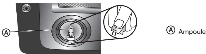
5. Aligner les trois languettes du protège-ampoule sur les orifices dans l'ouverture, puis pousser pour enclencher.
