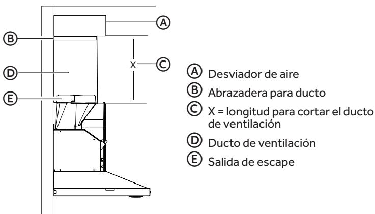
3. Corte el ducto según el tamaño medido (X).
