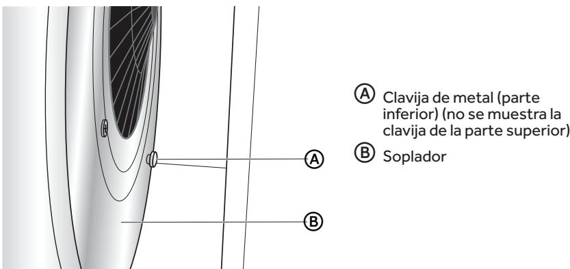
3. Coloque un filtro de carbón en la toma del soplador de los lados derecho e izquierdo y, luego, gire cada filtro levemente hasta que los ganchos del filtro envuelvan las clavijas.
