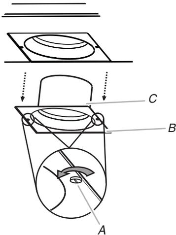
A. Vis de fixation du filtre à graisse
