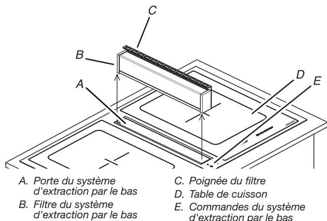
Le système d'extraction par le bas est prévu pour éliminer les vapeurs, odeurs et fumées de cuisson. Le système d'extraction par le bas se compose d'un filtre d'évacuation, d'un conduit de ventilation et d'un ventilateur d'évacuation.
