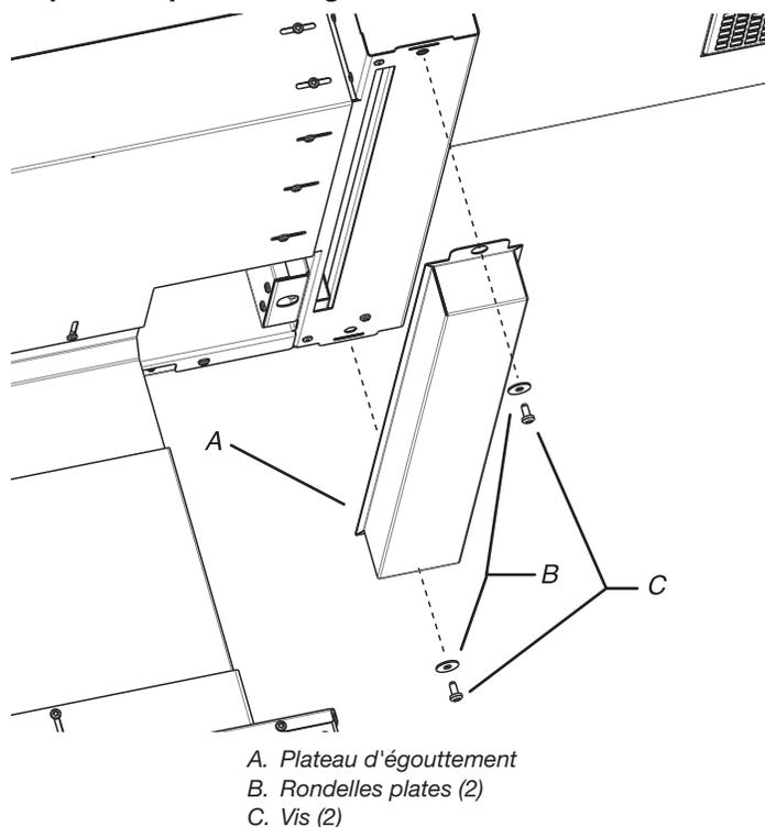
1. Utiliser un tournevis T20®† Torx® et ôter les 2 vis et rondelles des trous sur le plateau d'égouttement.
