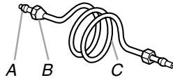
A. Manga de compresión C. Tubería de cobre B. Tuerca de compresión
