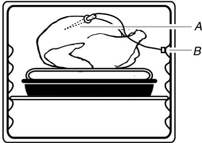
A. Connecteur de la sonde thermométrique
