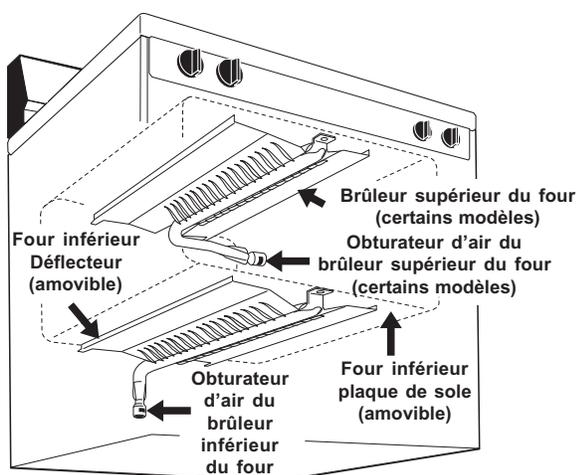
Fig. 20 - Emplacement des brûleurs du four
