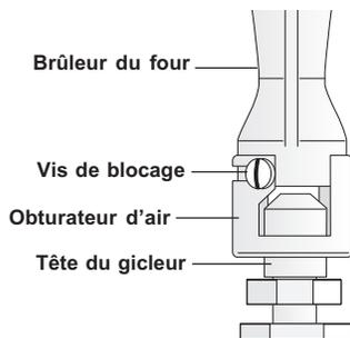
Fig. 21 - Obturateur d'air du brûleur du four
