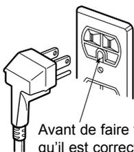
Avant de faire fonctionner l'appareil, vérifier qu'il est correctement relié à la terre
