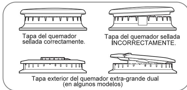
Para colocar correctamente la tapa exterior del quemador extra-grande dual, asegúrese de que la hendidura que se encuentra en la tapa del quemador quede situada sobre la guía de montaje de la cabeza del quemador. (LCG3091ST, 3691ST sólo)
