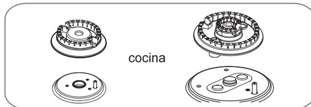
Las cabezas de los quemadores y el montaje de la cabeza/tapa del quemador oval son desmontables. Sencillamente desmóntelos extrayéndolos de la cocina para proceder a su limpieza.
