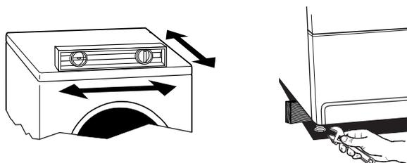
Si la sécheuse n'est pas de niveau, la déposer sur un bloc de bois. Utiliser une clé à molette pour ajuster les pieds vers le haut ou vers le bas, et vérifier à nouveau si elle est de niveau.
