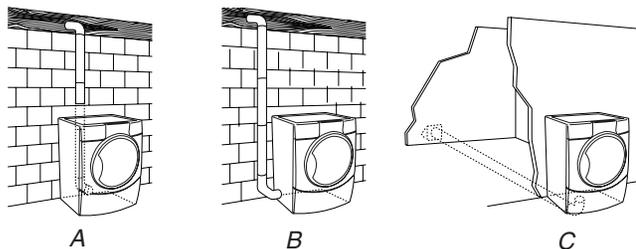
A. Acheminement standard du conduit d'évacuation par l'arrière
