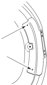
4. Déplacer la charnière de l'autre côté et la réinstaller avec les 4 vis enlevées à l'étape 2.
