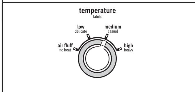
Sélectionner la température en tournant le bouton à la position désirée ou sélectionner le programme de séchage automatique dont la température figure dans les sélections de programme.
