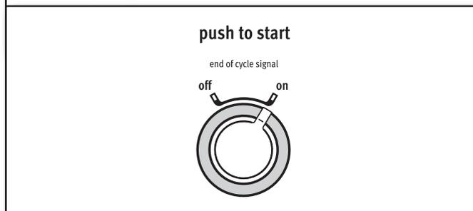
Tourner le bouton END OF CYCLE SIGNAL (signal de fin de programme) pour activer ou désactiver (On ou Off) le signal. Le signal de fin de programme est un signal sonore qui retentit lorsque le programme de séchage est terminé. Sortir rapidement les vêtements à la fin du programme réduit le froissement.
