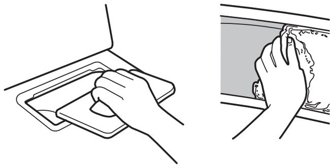
Nettoyer le filtre à charpie avant chaque charge. Tirer le filtre à charpie de son support. Enlever la charpie du filtre en la roulant avec les doigts. Ne pas rincer ni laver le filtre pour enlever la charpie. Remettre le filtre à charpie fermement en place.
