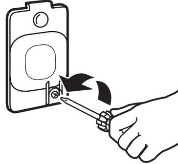
3. Tourner l'ampoule dans le sens antihoraire. Remplacer l'ampoule uniquement par une ampoule de 10 watts pour appareil électroménager. Réinstaller le couvercle et le fixer avec la vis.
