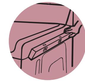
Vérifier l'aplomb à l'avant et sur les côtés de la laveuse.
