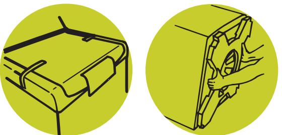
Le couvercle doit être immobilisé avec du ruban adhésif avant le déplacement de la laveuse.
