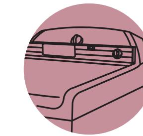
Contrôler l'aplomb en plaçant d'abord un niveau sur le couvercle près de la console.
