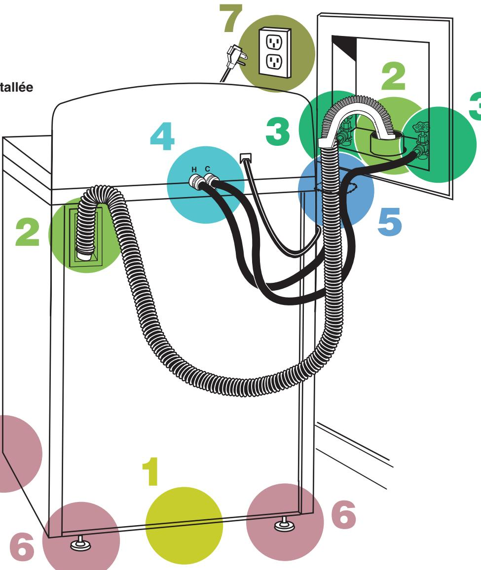
Déplacer la laveuse à son emplacement final et régler l'aplomb de la laveuse.
