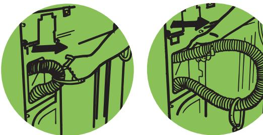
Localiser l'attache de fixation pour retirer le tuyau d'évacuation de la laveuse. Dégager complètement le tuyau d'évacuation de la laveuse en saisissant d'abord l'attache de fixation.
