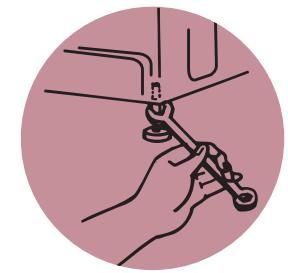
Si elle est d'aplomb, utiliser une clé plate de 7/16" ou 14 mm pour serrer l'écrou de blocage à la base de la laveuse.
