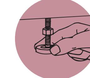
Appuyer sur le panneau avant supérieur pour vérifier que la laveuse repose sur les pieds arrière. Abaisser le pied avant droit sur le plancher. Manuellement, faire pivoter fermement le pied jusqu'à 1 1/2 tour supplémentaire. Faire basculer doucement la laveuse d'avant en arrière, transversalement et en diagonale pour vérifier que les quatre pieds sont bien en contact avec le plancher.
