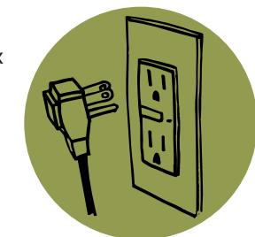
Brancher sur une prise à 3 alvéoles reliée à la terre. Vérifier s'il y a des fuites autour des robinets, des tuyaux d'arrivée d'eau et du tuyau d'évacuation.
