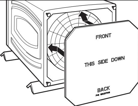
Orienter la plaque d'insonorisation en plaçant le bord intitulé FRONT (avant) vers l'avant de la laveuse. Les mots THIS SIDE DOWN (ce côté vers le bas) doivent être orientés vers l'extérieur.
