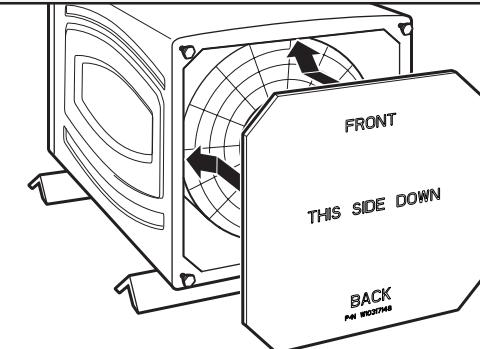
Coloque el aislador de sonido con el extremo que tiene la palabra FRONT (Frente) hacia el frente de la lavadora. Las palabras THIS SIDE DOWN (Este lado hacia abajo) deberán quedar hacia fuera.
