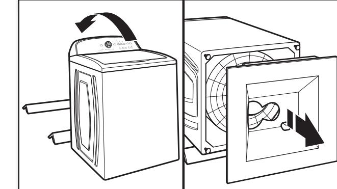
Afin d'éviter d'endommager le plancher et la laveuse, placer les supports en carton du carton d'expédition sur le plancher, derrière la laveuse. À l'aide d'au moins deux personnes, incliner la laveuse sur sa partie arrière, sur les supports de carton. Retirer la base d'expédition.
