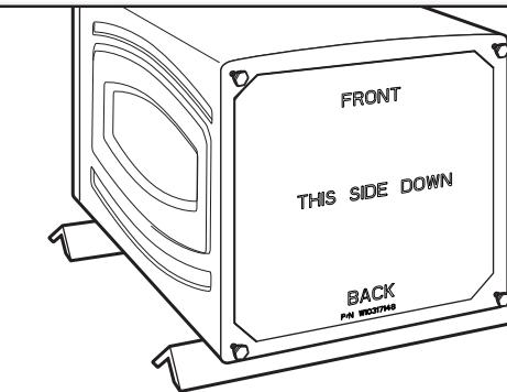
Comenzando con un lado, inserte el aislador de sonido dentro de la parte inferior de la lavadora para que quede detrás del marco. Coloque la lavadora en posición vertical.
