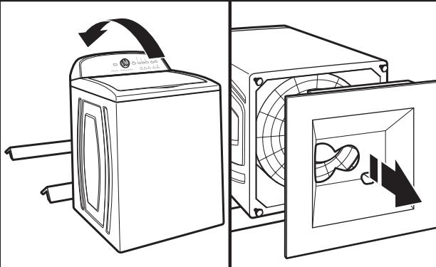
Para evitar dañar el piso y la lavadora, coloque soportes de cartón de la caja de transporte sobre el piso, detrás de la lavadora. Incline la lavadora hacia atrás con la ayuda de dos o más personas y colóquela sobre los soportes de cartón. Saque la base de transporte.
