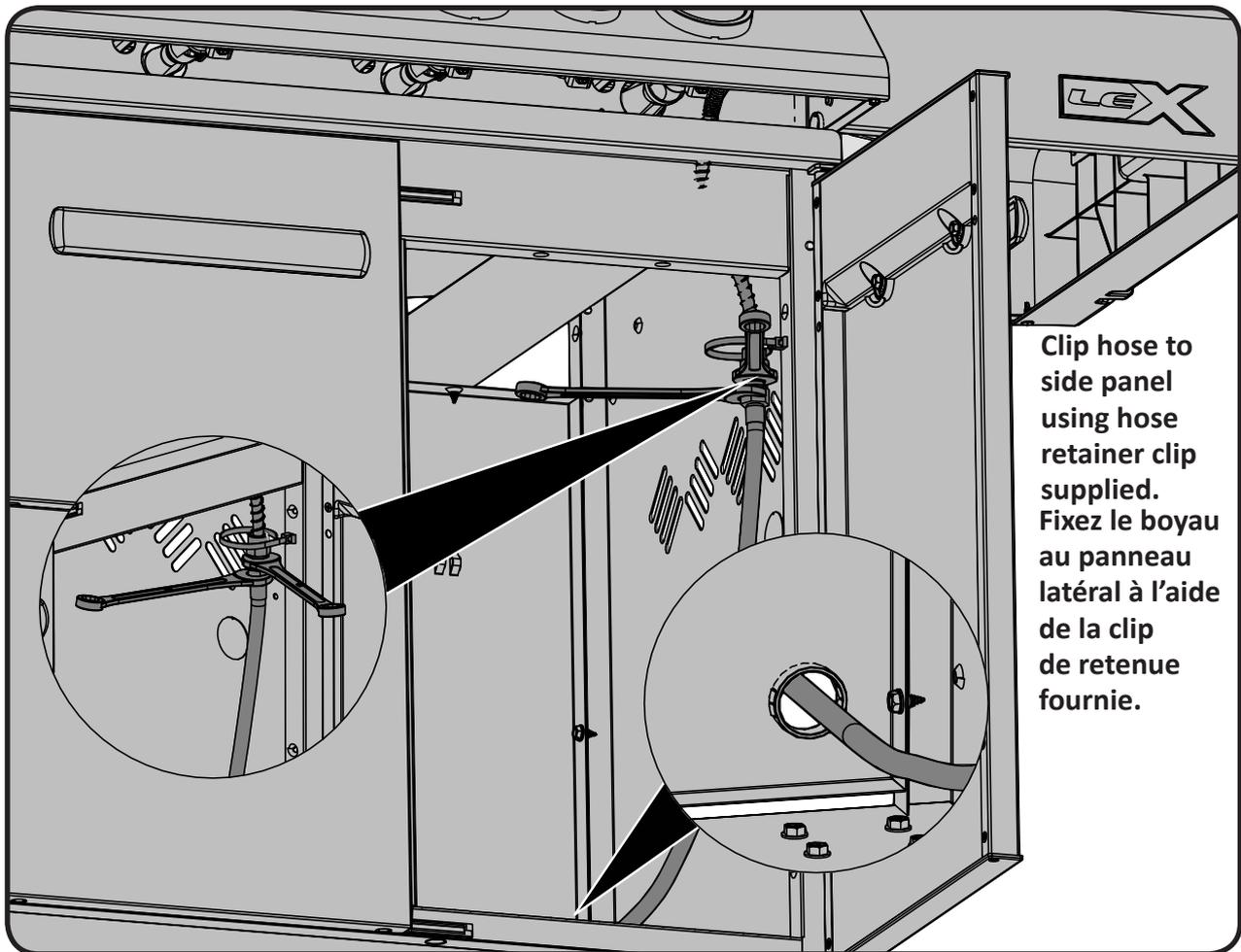
Clip hose to side panel using hose retainer clip supplied. Fixez le boyau au panneau latéral à l'aide de la clip de retenue fournie.
