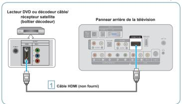
La configuration du panneau arrière de chaque lecteur DVD ou de chaque décodeur câble/récepteur satellite (boîtier décodeur) diffère. Branchez un câble HDMI entre la prise HDMI/DVI IN du téléviseur et la prise HDMI du lecteur DVD ou du décodeur câble/récepteur satellite (boîtier décodeur).
