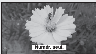
Numér. seul. Utilisez la fonction pour voir l'intégralité de l'image sans coupure lors de l'entrée de signaux HDMI (720p/1080i), Composante (1080i) ou DTV (1080i).
