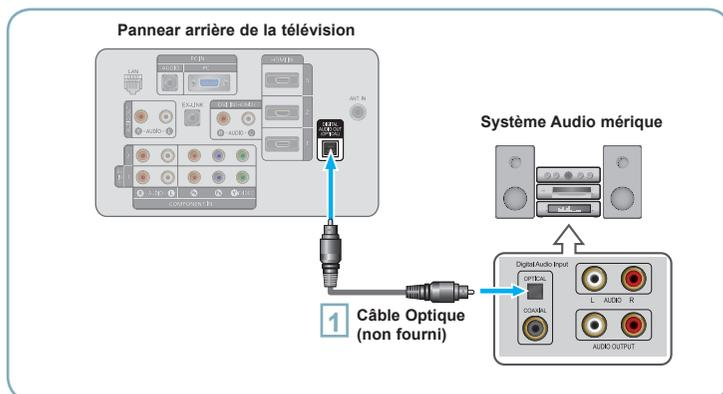
**1** Branchez un Câble optique entre les prises "DIGITAL AUDIO OUT (OPTICAL)" (Sortie audio numérique/Optique) du téléviseur et les prises d'entrée numérique du système audio numérique.
