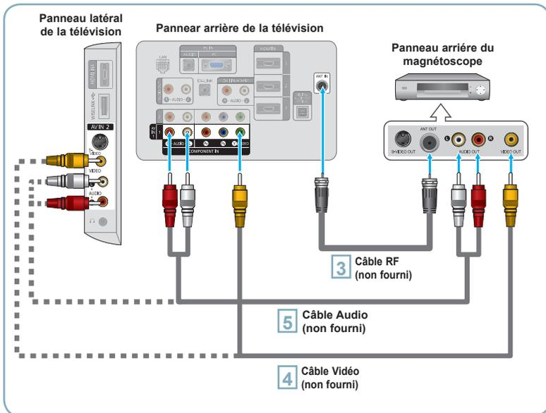
Suivez les instructions de "Visualisation d'une cassette à l'aide d'un magnétoscope ou d'un caméscope" pour visualiser une cassette à l'aide de votre magnétoscope.
