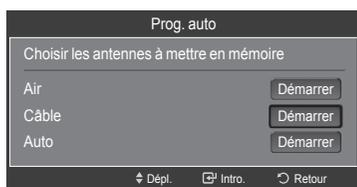
4 Au moment de la sélection du système de télévision par Câble : Appuyez sur **ENTER** pour amorcer la mémorisation automatique. Appuyer sur les touches **▲**, **▼**, **◀** ou **▶** pour choisir la source du signal analogique appropriée "STD", "HRC", ou "IRC". Appuyer sur la touche **▲** ou **▼** pour sélectionner "Démarrer", puis sur **ENTER**. Si le Câble est numérique, sélectionner la source de signal pour une diffusion analogique et numérique.
