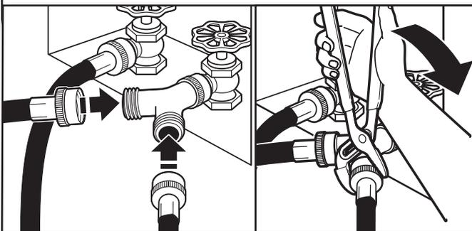
L'une des extrémités du tuyau long comporte un treillis métallique à l'intérieur du raccord. Fixer cette extrémité au connecteur en "Y". Fixer le tuyau d'alimentation en eau froide de la laveuse à l'autre extrémité du raccord en "Y". Visser le raccord à la main pour qu'il repose sur le connecteur. Terminer le serrage des raccords - deux tiers de tour supplémentaires avec une pince.
