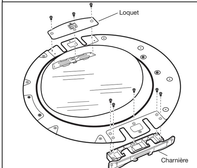
À l'aide d'un tournevis Torx®† T25, retirer les 3 vis Torx fixant la plaque de protection du loquet et la plaque de support du loquet; retirer aussi les 5 vis maintenant la charnière en place.
