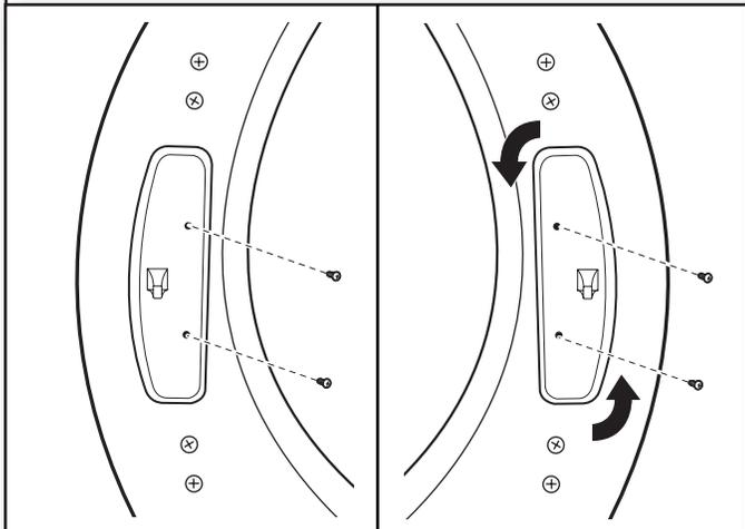
À l'aide d'un tournevis Torx®† T25, retirer les 2 vis fixant la gâche de la porte au châssis de la porte de la sécheuse. Faire pivoter la gâche de 180° et la fixer au côté opposé du châssis de la porte de la sécheuse, tel qu'indiqué.
