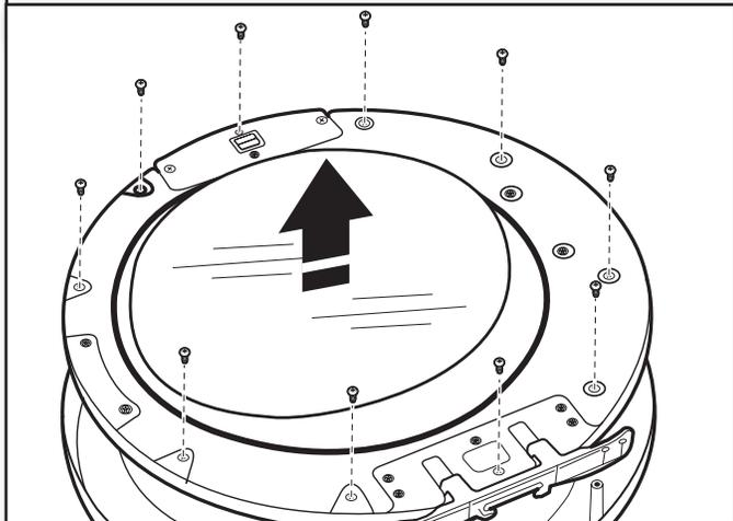
Positionner la porte de façon à ce que l'intérieur de la porte soit orienté vers le haut. À l'aide d'un tournevis Phillips, retirer les 10 vis fixant la porte interne à la porte externe. Soulever la porte interne pour la dégager et la mettre de côté.
