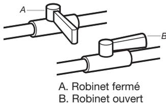
Ouvrir le robinet d'arrêt du conduit d'alimentation; le robinet est ouvert lorsque la poignée est parallèle au conduit. Puis vérifier tous les raccordements en les badigeonnant d'une solution de détection des fuites non corrosive approuvée. L'apparition de bulles indique la présence d'une fuite. Réparer toute fuite éventuelle.
