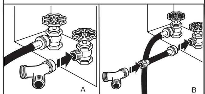
Si l'espace le permet, fixer l'embout femelle du connecteur en "Y" au robinet d'eau froide. Voir figure A.
