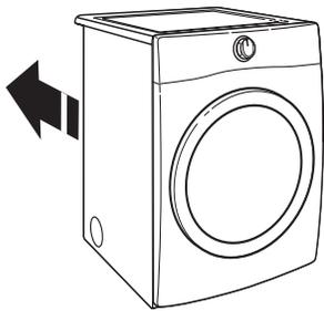
Déplacer la sécheuse à son emplacement final en prenant soin de ne pas écraser ou déformer le conduit d'évacuation ou la canalisation de gaz souple.
