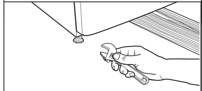
Si la sécheuse n'est pas d'aplomb, la relever à l'aide d'un bloc de bois, utiliser une clé pour ajuster les pieds vers le haut ou vers le bas, et vérifier à nouveau si elle est d'aplomb. Une fois la sécheuse d'aplomb, s'assurer que les quatre pieds sont en contact ferme avec le plancher et que la sécheuse ne tangue pas.
