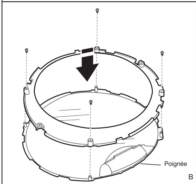
À l'aide d'un tournevis Phillips, retirer les 4 vis du support de la partie externe du hublot et extraire l'anneau de garniture de la fenêtre (A). Faire pivoter l'anneau de garniture à 180° et fixer les 4 vis retirées à l'étape précédente (B).
