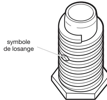
Examiner les pieds de nivellement, trouver le symbole de losange. Introduire manuellement les vis des pieds dans les trous, utiliser une clé à molette pour visser les pieds jusqu'à ce que le symbole de losange ne soit plus visible.
