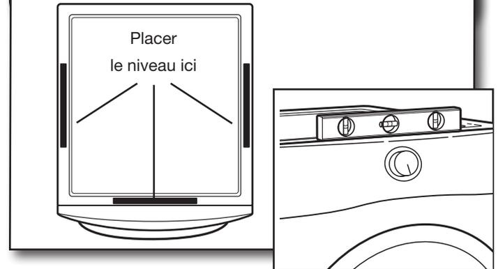
Vérifier l'aplomb de la sécheuse d'un côté à l'autre. Répéter l'opération de l'avant vers l'arrière.
