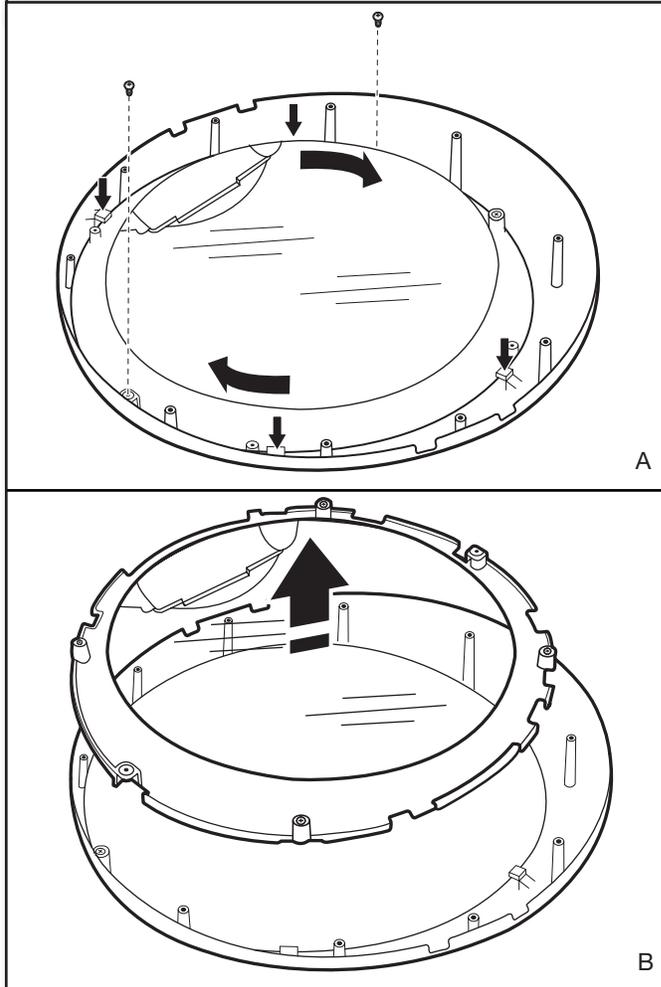
À l'aide d'un tournevis Phillips, retirer les 2 vis du support de la partie externe du hublot et faire pivoter la partie externe du hublot dans le sens horaire jusqu'à ce que les indentations carrées soient alignées avec les 4 onglets de la garniture circulaire aux emplacements indiqués par les flèches dans l'illustration A ci-dessus. Soulever ensuite la partie externe du hublot et le support, et les dégager de la garniture circulaire - les mettre de côté (B).
