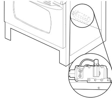
2. À l'aide d'une clé à molette, tourner le gicleur du brûleur de cuisson au four au gaz propane numéro .0512 dans le sens antihoraire pour le retirer.
