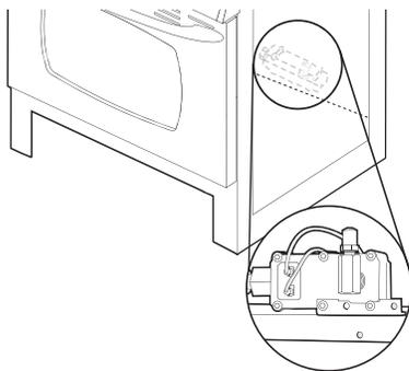
2. À l'aide d'une clé à mollette, tourner le gicleur du brûleur de cuisson au four au gaz naturel numéro 49 dans le sens antihoraire et le retirer.
