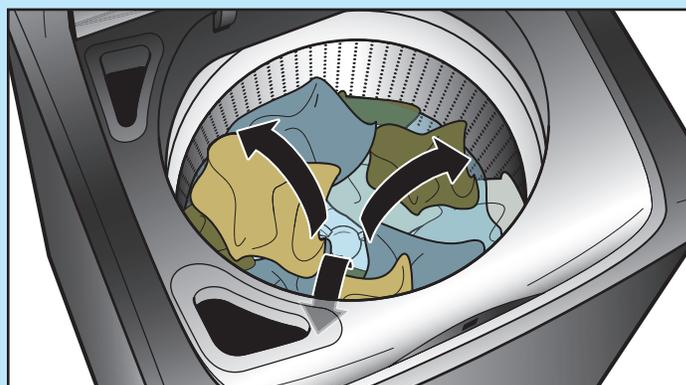
L'impulseur déplace la charge dans l'eau en utilisant moins d'eau et d'énergie qu'une laveuse traditionnelle de type agitateur.
