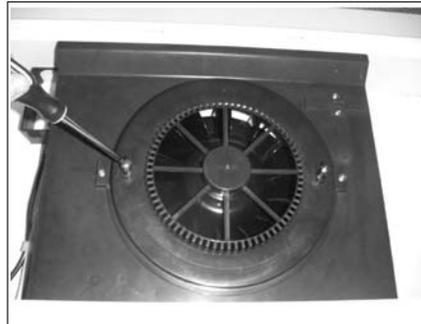
1. Fixez les deux attaches à ressort au boîtier de la grille de protection (A). Pour y parvenir, faites passer la vis à travers le ressort puis fixez-la à l'attache. Fixez solidement l'attache au boîtier de la grille de protection à l'aide d'un tournevis à pointe cruciforme (Phillips).
