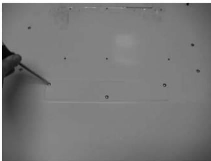
4. Retirez les vis de la plaque supérieure de reprise d'air. La plaque se trouve sur le dessus de la hotte, près de la partie avant.
