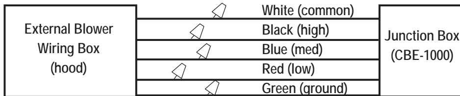
CBE-1000: WIRING DIAGRAM
