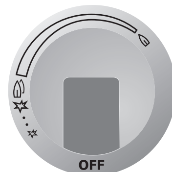
Bouton de commande du brûleur à deux flammes.
