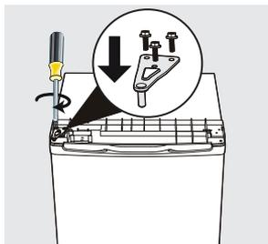
8. Coloque la puerta superior en la parte trasera y ajuste con 2 tornillos.
