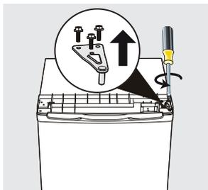
4. Desatornille la bisagra inferior. Quite las patas de nivelación de ambos lados.
