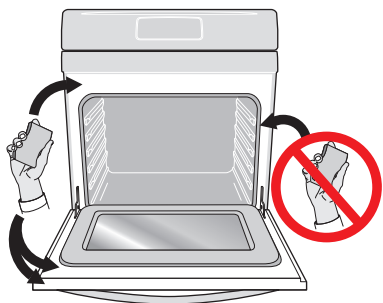
Figure 24 : Nettoyer autour du joint de porte du four
