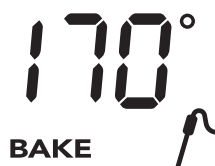
Figure 19 : Sonde détectée affichant sa température
