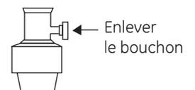
**Conseil**: Il faut éviter les frais d'intervention inutiles. Il faut toujours s'assurer que le bouchon de vidange a été enlevé avant de brancher le tuyau de vidange du lave-vaisselle au broyeur à déchets.
