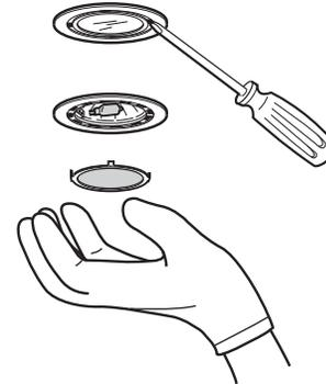
3. Enlever la lampe. Installer une lampe à halogène neuve de 120 V/40 W maximum, à culot de type G-9.
